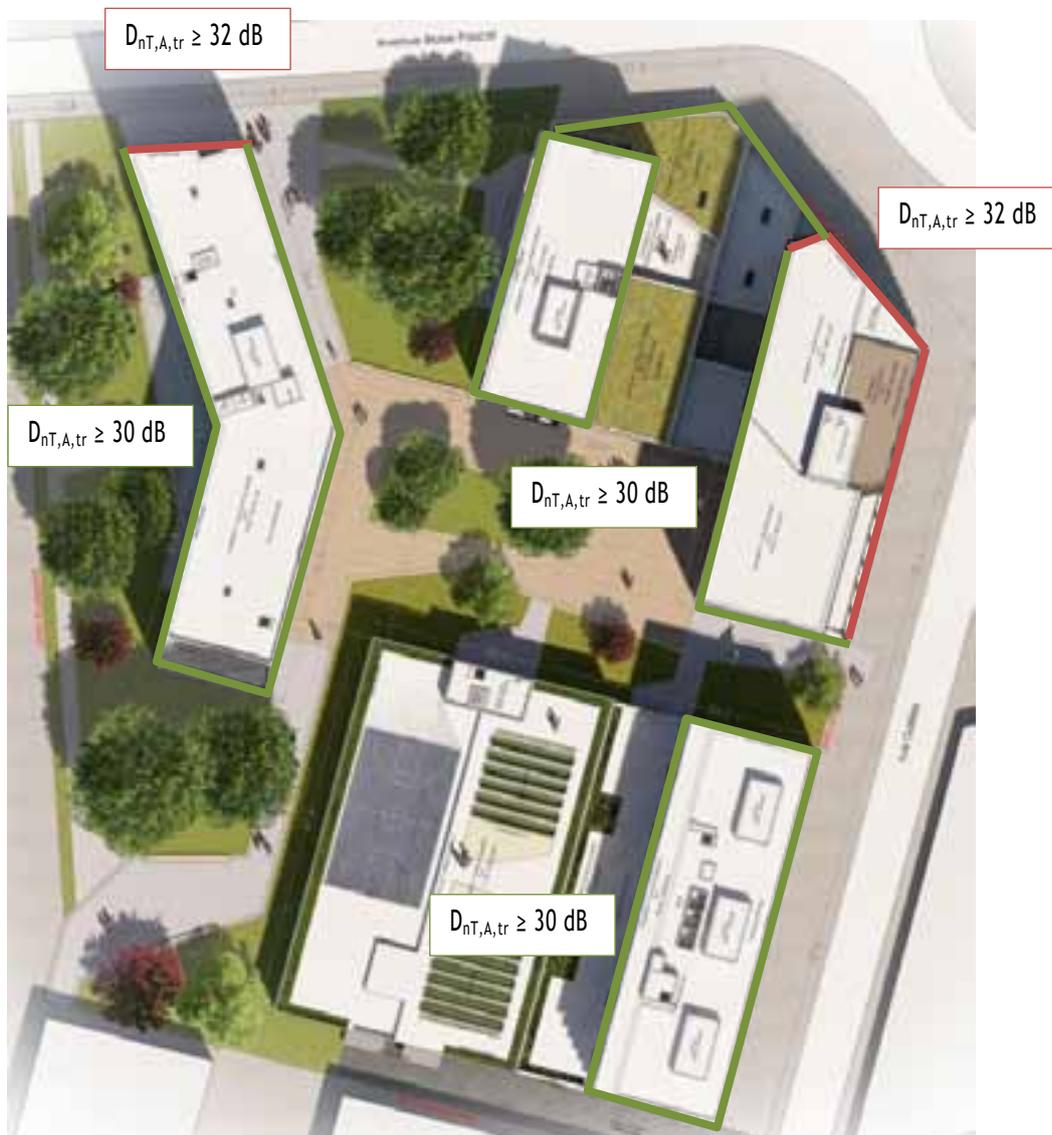
Ces isollements de façade n'entraînent pas de difficultés techniques particulières. Les prescriptions acoustiques sur les façades seront données en phase APD (performances des châssis vitrés, entrées d'air, coffres de volet roulant...).
