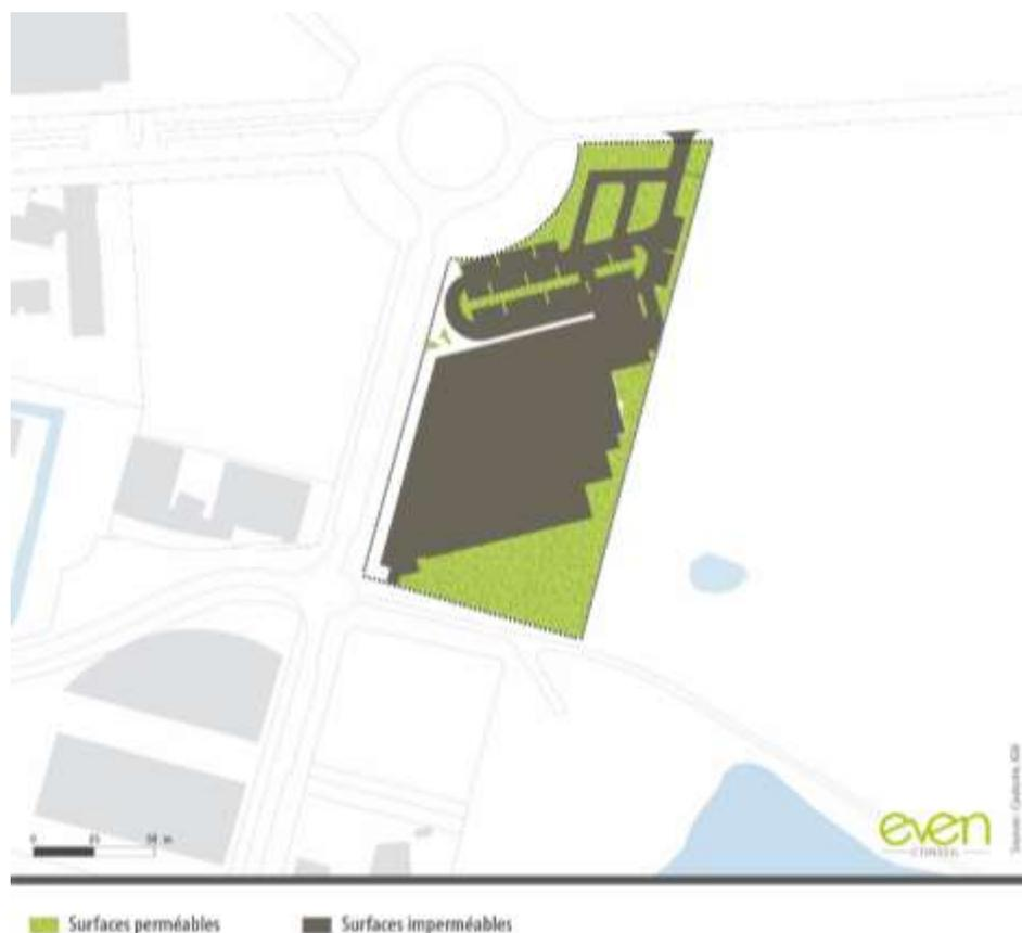
Surfaces perméables/ imperméables générées par le projet – Source : Even Conseil
